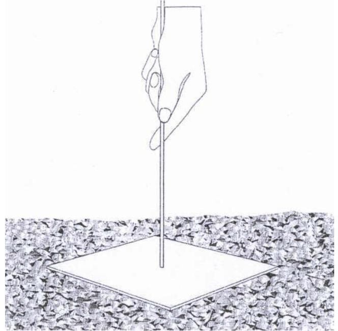
Cet équipement est complété par une règle métallique graduée en millimètres et de longueur suffisante pour lire en une fois l'épaisseur sur la tige.
